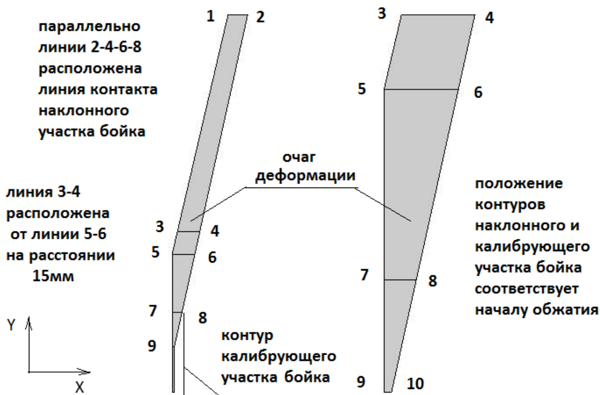
Рис. 3. Положение очага деформации, наклонного и калибрующего участка бойка перед началом рабочего хода для обеспечения выхода полосы
